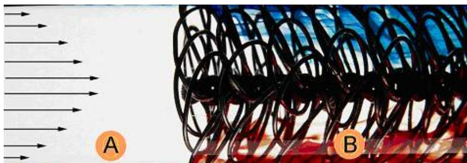
図 3 : 管壁染料流れのワイヤー3次元素子による混合
